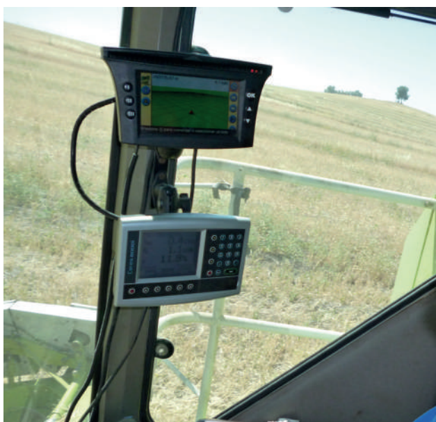
Figura 5. Sistema de ayuda al guiado mediante barra de luces, arriba, y monitor de rendimiento, abajo, montado en cosechadora.
