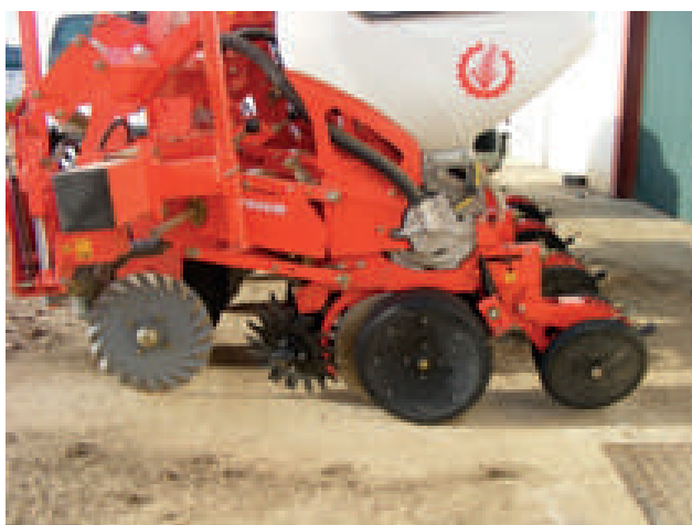
Figura 8. Ejemplo de equipo siembra directa compuesto de (comenzando por la izquierda): disco de corte de residuos y preparación previa del terreno; discos tipo "soles" para despeje de restos sobre la línea de siembra; discos abresurcos (van en forma de V) con rueda de goma que actúa como control de profundidad. En el interior va el tubo que deposita las semillas en el suelo; por último, se sitúan los discos de cierre de surco.
