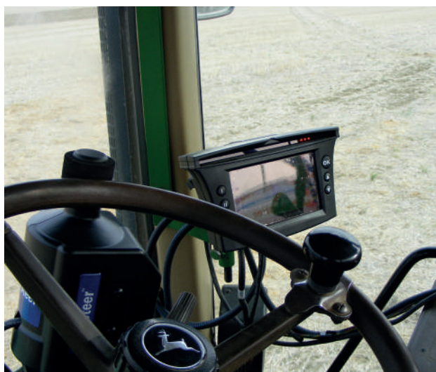
Figura 6. Sistema de guiado automático móvil "EZSteer" acoplado al volante del tractor
