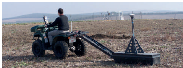
Figura 16. Sonda EM 38 arrastrada por quad
