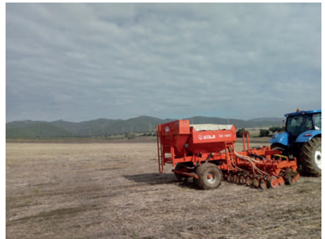
Figura 11. Sembradora directa con tolva para la semilla junto al tractor y tolva trasera de abono microgranulado.
